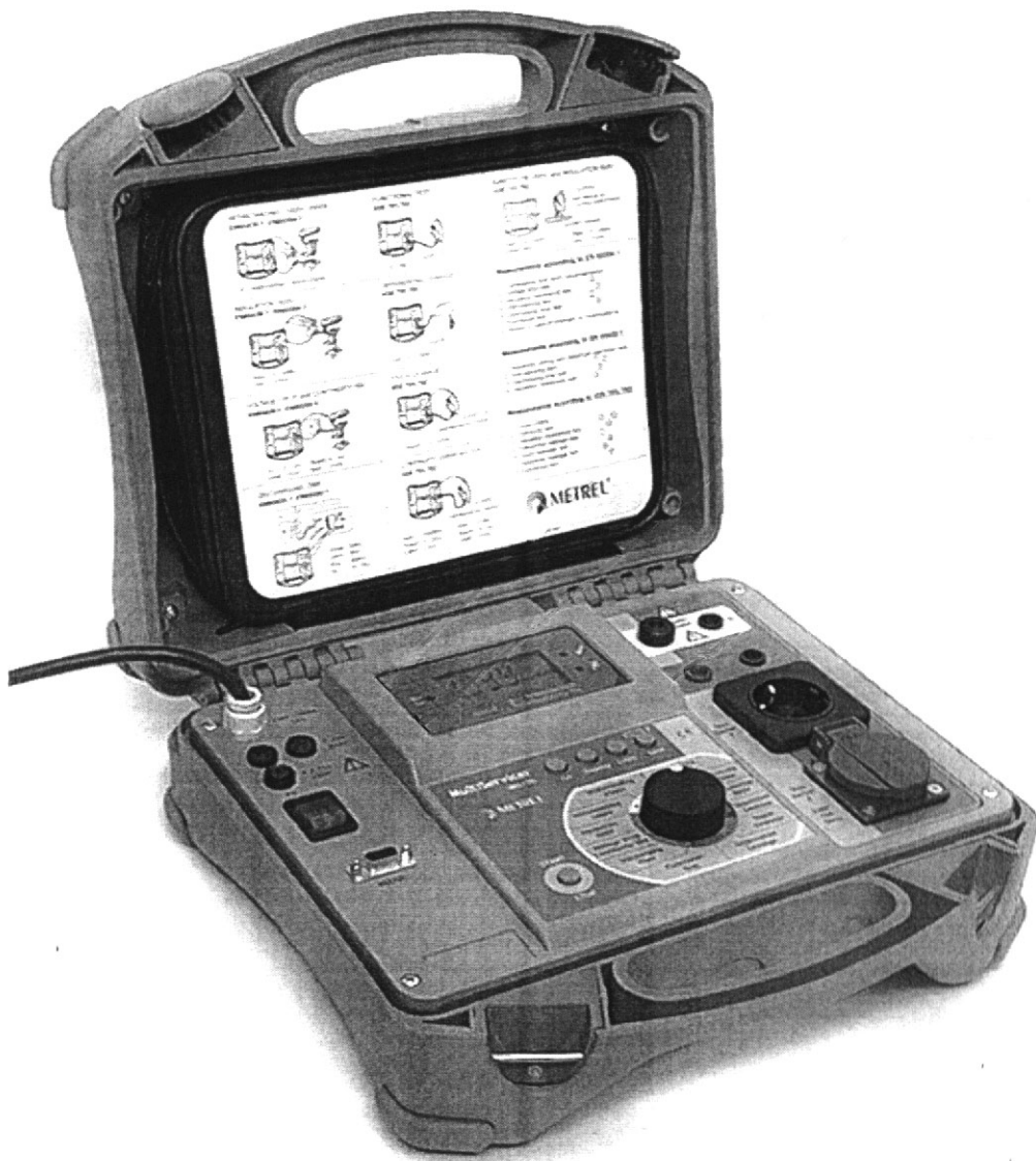
Slika 1. Višenamjensko mjerilo zaštite električnih uređaja tip Multiservicer MI 2170
